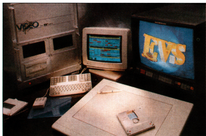
Sådan ser paintbox herlighederne ud. Skærmen til venstre benyttes udelukkende til menustyringen af paintbox'en. Til højre ses den 20" skærm, som selv resultatet kan ses på. Bemærk også det lille fikse keyboard.
